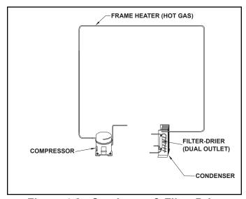
Figure 4-2. Condenser & Filter-Drier
