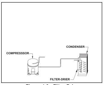
Figure 4-9. Filter-Drier
